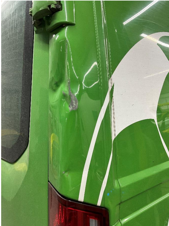
Abbildung 1: Originalschaden vor Instandsetzung [MRM fair claim GmbH]
