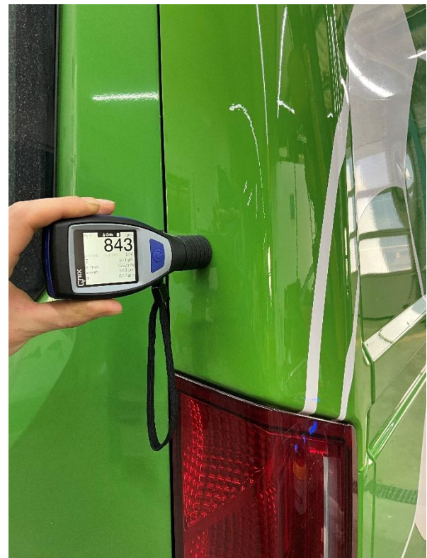
Abbildung 4: Schichtdickenmessung nach Abschluss der Decklackierung [MRM fair claim GmbH]
