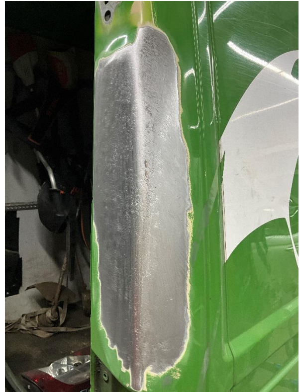
Abbildung 2: Blechinstandsetzung abgeschlossen [MRM fair claim GmbH]
