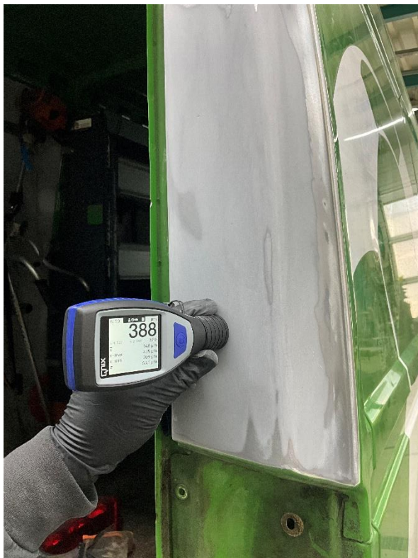
Abbildung 3: Schichtdickenmessung nach Auftrag von Karosseriefüllmasse / Schwemzzinnersatzmaterial [MRM fair claim GmbH]
