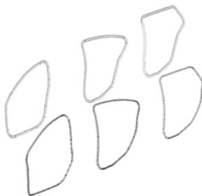
*„Die genannten Türdichtungen sind mit Kunststoff -Clipsen sowie einem integrierten doppelseitigen Klebeband an der Tür befestigt. Somit ist keine zerstörungsfreie Demontage möglich. Hierzu wird eine entsprechende Änderung der Herstellerdokumentation erfolgen. Audatex und DAT werden ebenfalls umgehend informiert. Nach der Aktualisierung wird nur die Möglichkeit „Erneuerung“ des Dichtungsgummis zur Verfügung stehen.“*
