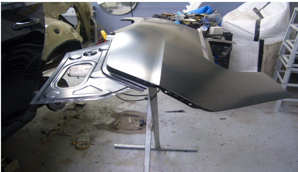
Bild 2: Seitenwand nach Abtrennen der nicht benötigten Teile
