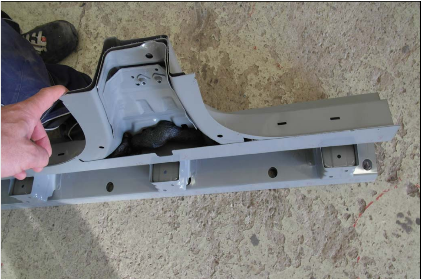
Bild 3: Schwellerteilersatz inkl. Verstärkungen und Innenschweller sowie Verstärkung B.-Säule tw.
