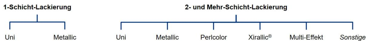
Abbildung 2: Unterteilung von Decklacken nach Schichten und Effekten.
