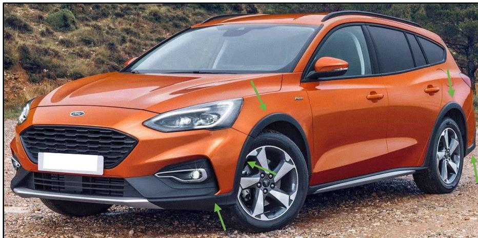
Bild 1: Ford Focus ACTIVE mit umlaufenden Kunststoffschutzleisten | Quelle: Ford Werke GmbH
