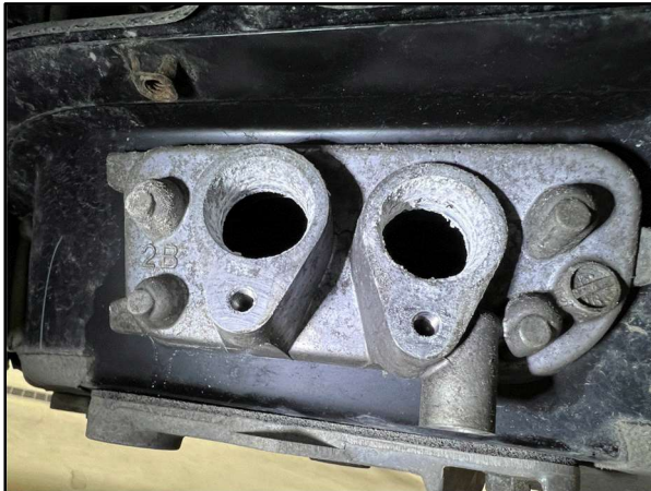
Bild 1+2 Anschluss HV-Akkumulator, korrodierte HV Muffen und HV-Ladekabelhalter Mitsubishi Outlander
