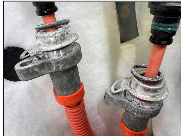
Bild 1+2 Anschluss HV-Akkumulator, korrodierte HV Muffen und HV-Ladekabelhalter Mitsubishi Outlander
