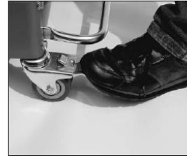
Gerät durch Feststellbremse gegen Wegrollen sichern.
