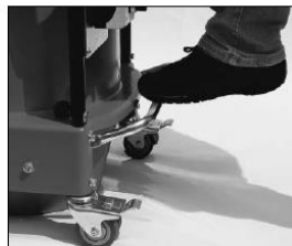
Fußhebel nach unten drücken. Staubwanne wird fest und dicht arretiert.
