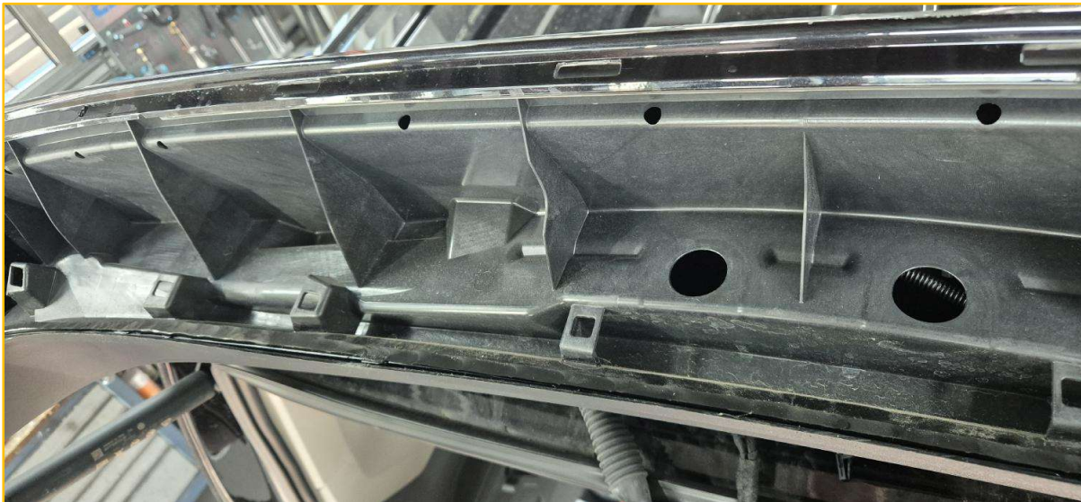
Bild 6: Werkstattdbild, Innenansicht Rahmen Heckklappe mit Kabeldurchführungen
