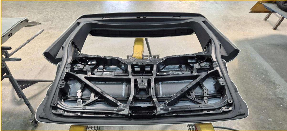
Bild 5: Werkstattdbild, Anlieferungszustand Neuteil Heckklappe Innenansicht
