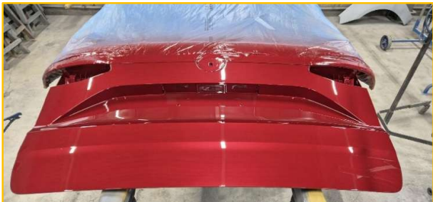
Bilder 11+12: Werkstattbilder, Lackierung Heckklappe im unteren Bereich inkl. Abdekarbeiten
