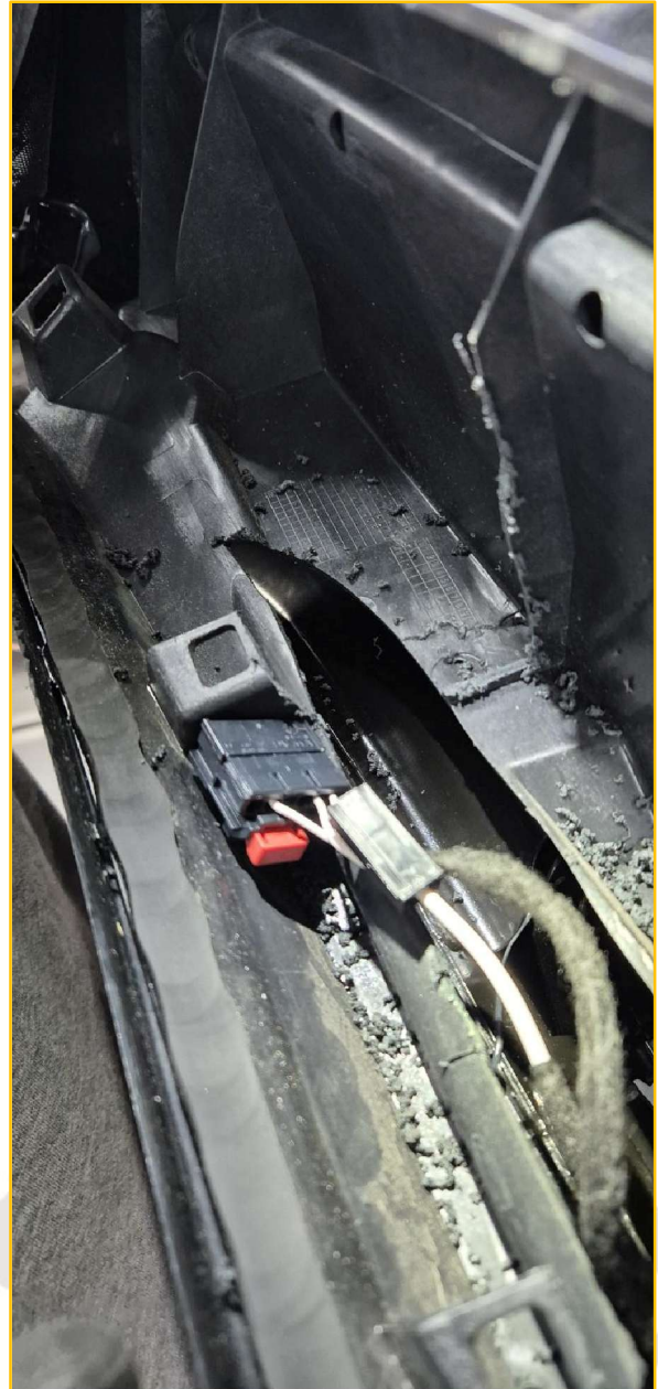
Bilder 7+8: Werkstattbilder, „Alte Heckklappe“ mit aufgeschnittenem Rahmen zur Demontage der Kabel und Schläuche
