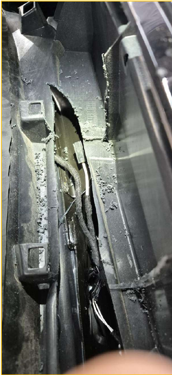
Bilder 7+8: Werkstattbilder, „Alte Heckklappe“ mit aufgeschnittenem Rahmen zur Demontage der Kabel und Schläuche
