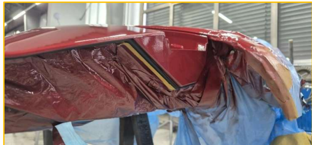
Bilder 11+12: Werkstattbilder, Lackierung Heckklappe im unteren Bereich inkl. Abdekarbeiten
