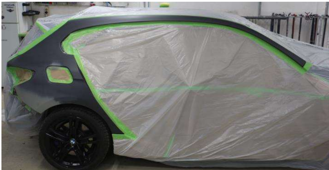
Abbildung 2: Zur Decklackierung vorbereitetes Fahrzeug mit Reparaturlackierung der hinteren Seitenwand und ergänzendem Mitlackieren der A-Säule oben außen, um eine geschlossene Klarlackschicht zu erreichen.
