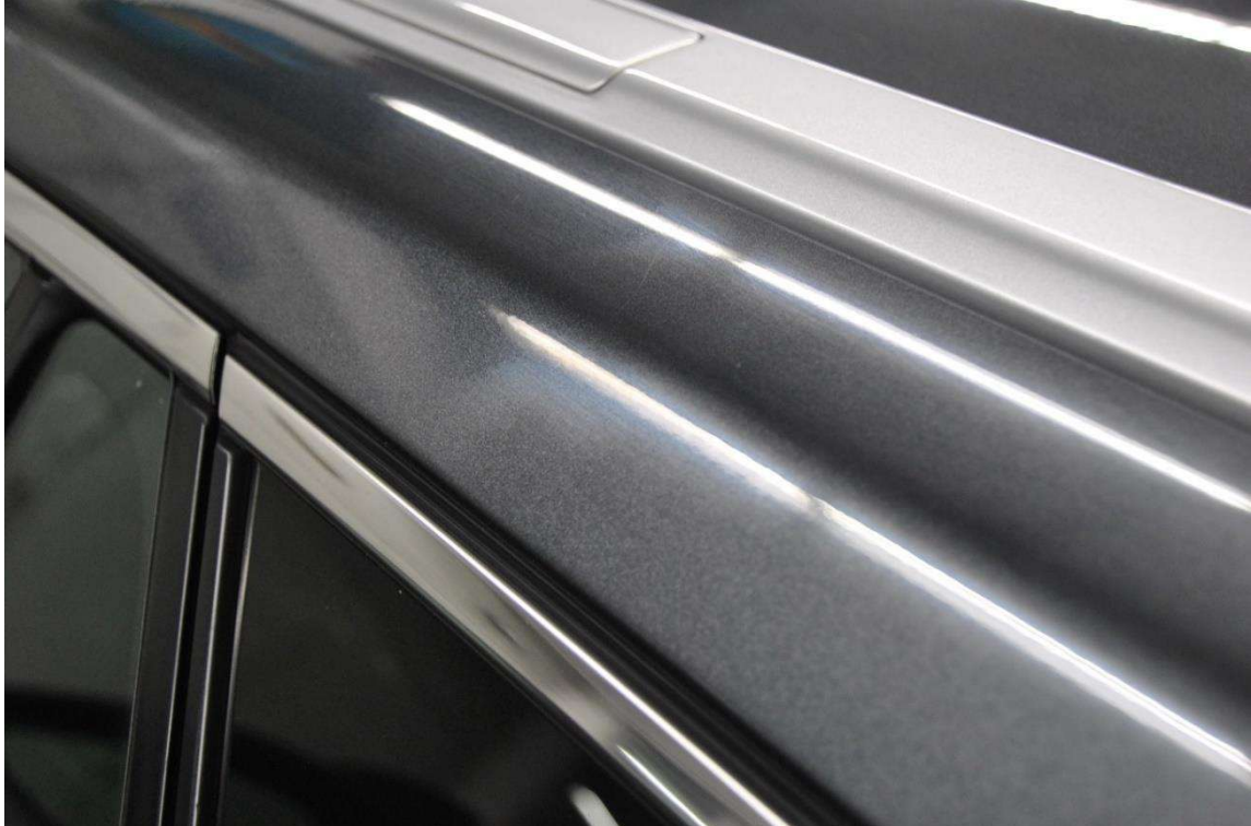
Abbildung 6: Potenzielle Spätfolge eines auslaufenden Lackierens im Bereich des Dachholms – Glanzgradreduzierung / Mattierung durch kontinuierliche Witterungseinflüsse und Alterung.
