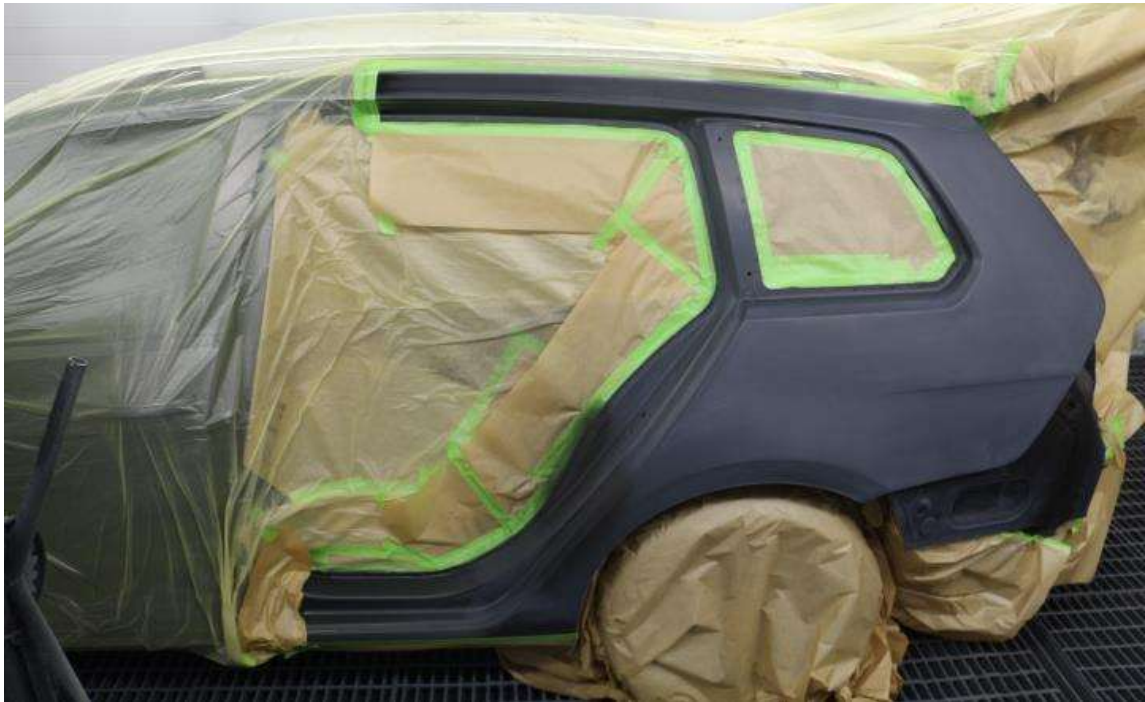
Abbildung 3: Zur Decklackierung vorbereitetes Fahrzeug mit Reparaturlackierung der hinteren Seitenwand und auslaufendem Lackierverfahren am Dachholm und im Bereich des hinteren Einstiegschwellers.
