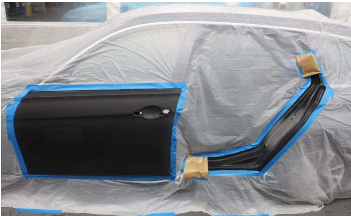
Abbildung 4: Zur Decklackierung vorbereitetes Fahrzeug mit Reparaturlackierung des hinteren Kniestücks innen durch das auslaufende Lackierverfahren am unteren Einstiegschweller und entlang der inneren C-Säule.
