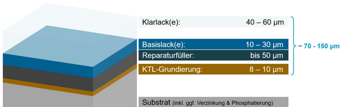
Abbildung 2: Schematischer Aufbau einer Neuteillackierung (unbeschädigtes Montageteil) inkl. Angabe von Einzelschichtdicken [AZT Automotive GmbH].
